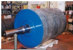
پولی محرک با شافت بلند جهت اتصال در حفره گیربکس
